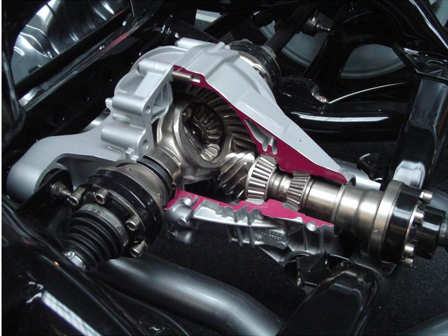
Figure 32: vue intérieure d'un différentiel de voiture
