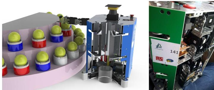
Figure 5: CAO du bras en action (à gauche) et vue de détail du bras rangé dans le robot (à droite).
