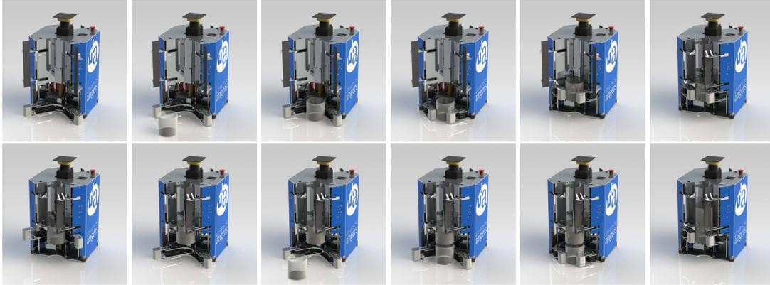
Figure 4: séquence de ramassage et empilage des verres.
