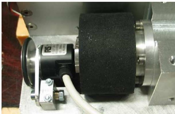
Figure 2: roue motrice associée à une roue incrémentale indépendante (photo:  $\mu$ art).
